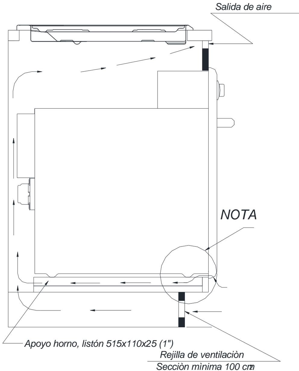
**NOTA:** Fijar el horno con dos tornillos a través de los dos agujeros localizados en los patines de frente.
