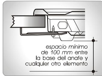
EN MESADAS DE 20 Y 30 mm. DE ESPESOR
