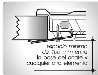
EN MESADAS DE 40 mm. DE ESPESOR
