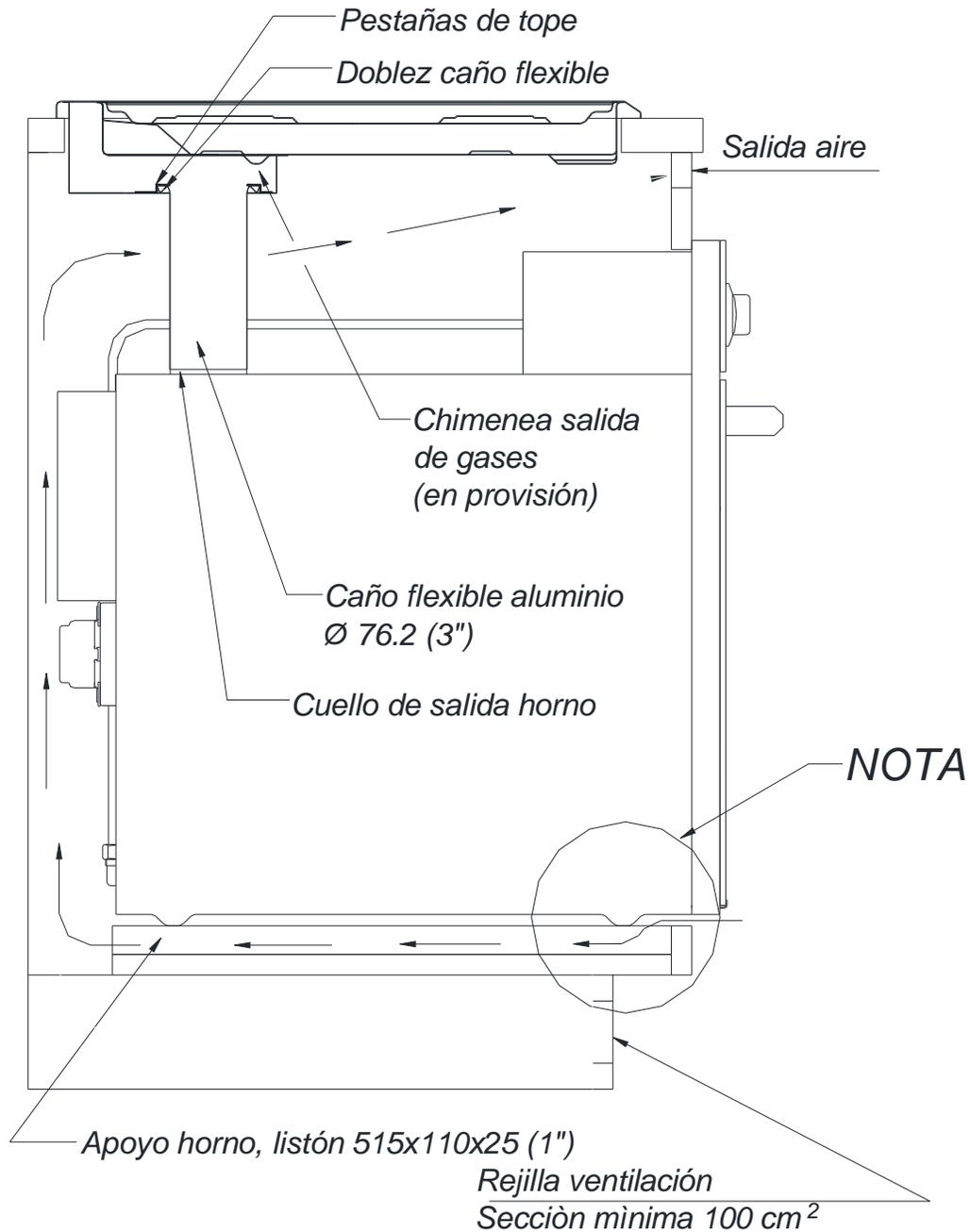
**NOTA:** Fijar el horno con dos tornillos a través de los dos agujeros localizados en los patines de frente.
