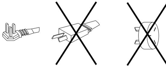
Si el tomacorriente no estuviera a la vista, (por ejemplo, debajo de la mesada, o dentro del mueble), deberá colocarse necesariamente en la línea de alimentación del tomacorriente un interruptor bipolar con capacidad para 10 Amperes, en posición fácilmente accesible, junto al artefacto.
